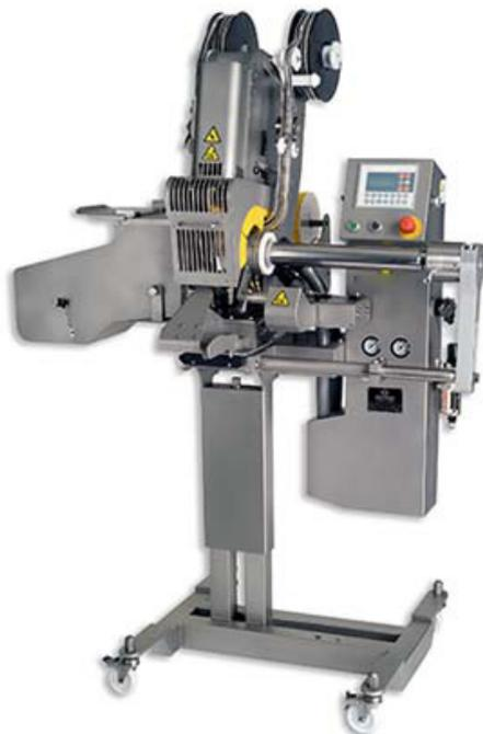
**CAPACITES :** calibre Ø 135mm maxi (boyaux artificiels)
