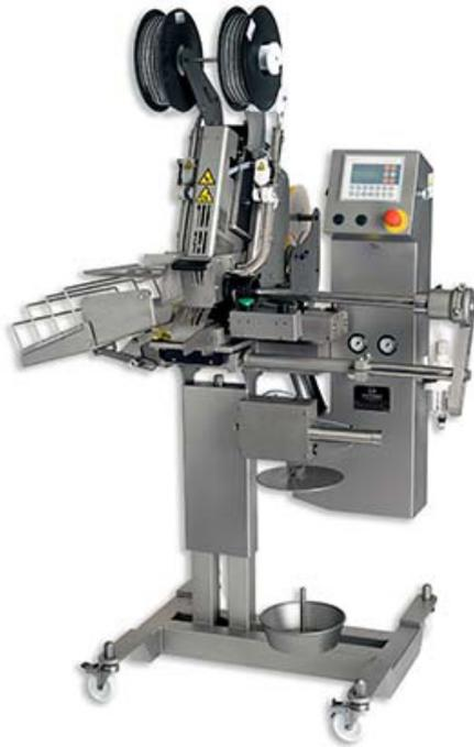
**CAPACITES :** calibre Ø 60mm maxi (boyaux artificiels)
